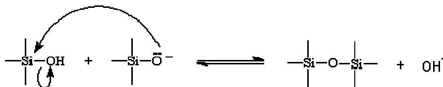
Fig. 19. Fase conclusiva della reazione: condensazione dell'alcolossido di silicio a silice con la conseguente perdita d'acqua.
