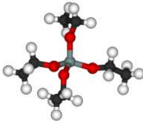
Fig. 13. Struttura del tetraetilortosilicato (TEOS). L'atomo di silicio è evidenziato in grigio, gli atomi di ossigeno sono in rosso, gli atomi di idrogeno in bianco e quelli di carbonio in nero.
