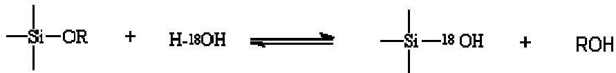
Fig. 14. Reazione di idrolisi di un alcossido di silicio con acqua arricchita con ^{18}\text{O} .
