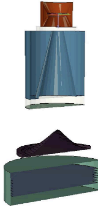
Figura 2.2: Rappresentazione di alcuni componenti della testata radiante utilizzati nella simulazione: bersaglio, collimatore primario, finestra di berillio, filtro di appiattimento e camere monitor.
