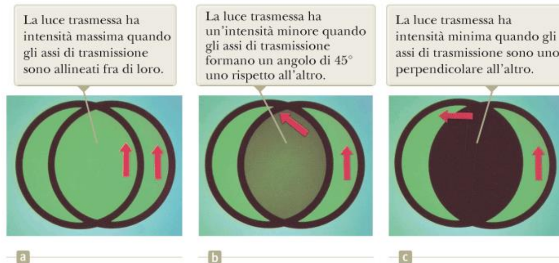
Figura 24.14 L'intensità della luce trasmessa da due polarizzatori dipende dall'orientazione relativa dei loro assi di trasmissione. Le frecce rosse indicano gli assi di trasmissione dei polarizzatori.
