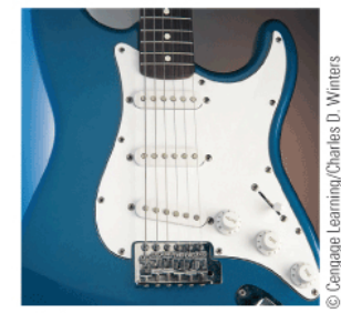
Figura 23.6 (a) In una chitarra elettrica, una corda magnetizzata che vibra induce una f.e.m. nella bobina di pickup. (b) I pickup (i cerchi sotto le corde metalliche) di questa chitarra elettrica rivelano le vibrazioni delle corde e mandano questa informazione, attraverso un amplificatore, alle casse acustiche (un interruttore sulla chitarra permette al musicista di selezionare i pickup da usare).
